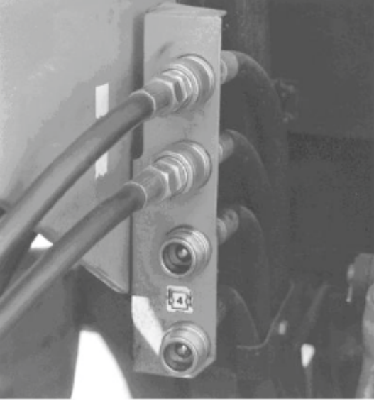
Şek. 17 hidrolik boruların traktöre bağlanması
