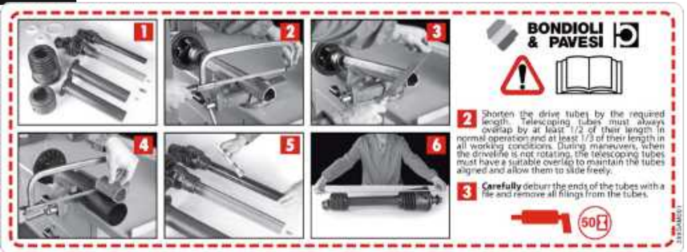
Şekil. 9. PTO mili kısaltma talimatı
