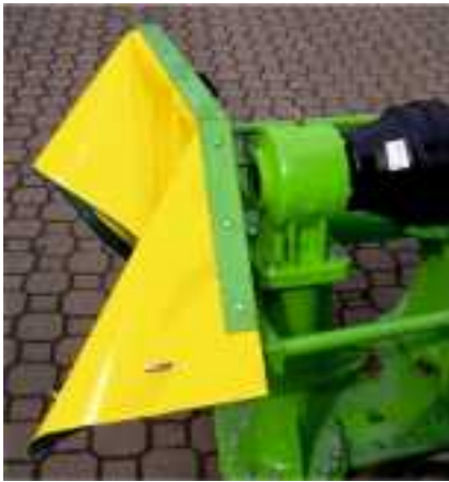
Şekil 7a. Makine yan koruyucusunun taşıma için yukarı kaldırılması
