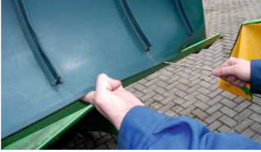
Şekil. 25. Kirlerin kayışın içinden çıkarılışı
