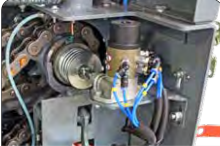
Otomatik Zincir Yağlama Sistemi (İsteğe Göre Otomatik Ve Manuel Hale Getirilebilir)
