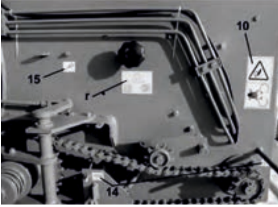
Şek. 10. Balya makinesi sağ tarafında görülebilen ikaz işaretleri ve bilgilendirme etiketleri (kapakların altında): 10 – Sürgü zincirleri 14 – Gresyağlama, 15 – Sıvı yağla yağlama r – sicim ayar şeması.
