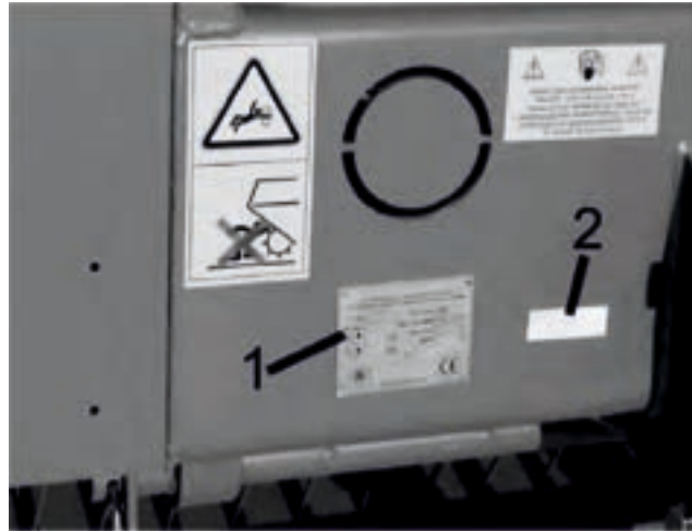
Şek. 1 Balya makinesinin tanıtım plakası ve seri numarasının görünümü; 1- Üretici plakası, 2- Gövdedeki seri numarası
