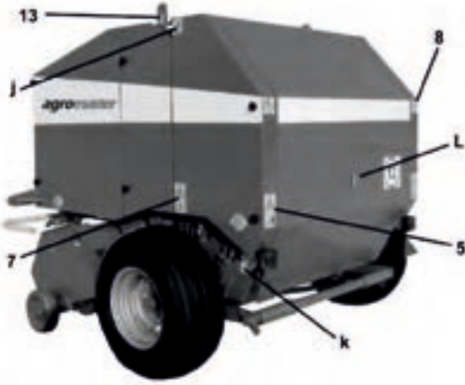
Şek.. 6. Balya makinesi sol tarafında görülebilen ikaz işaretleri ve bilgilendirme etiketleri:
