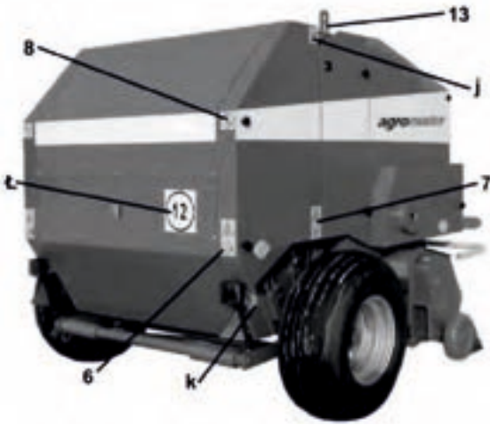
Şek. 7. Balya makinesi sağ arka tarafında görülebilen ikaz işaretleri ve bilgilendirme etiketleri:
